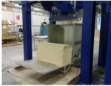
Molde con desmoldeo motorizado
