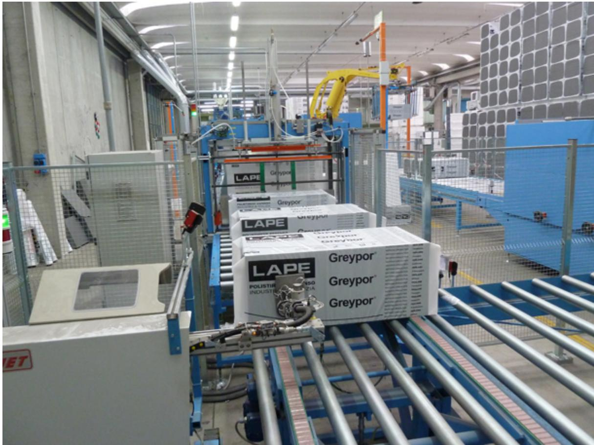
Supervisión para la gestión centralizada de la receta de producción - Para las máquinas más completas existe la posibilidad de memorizar una “receta” en la PC de la primera estación de la línea todos los parámetros de control de la máquina entera. Estos parámetros siguen el bloque desde la estación inicial del tren hasta el final de la línea de forma totalmente automática.
