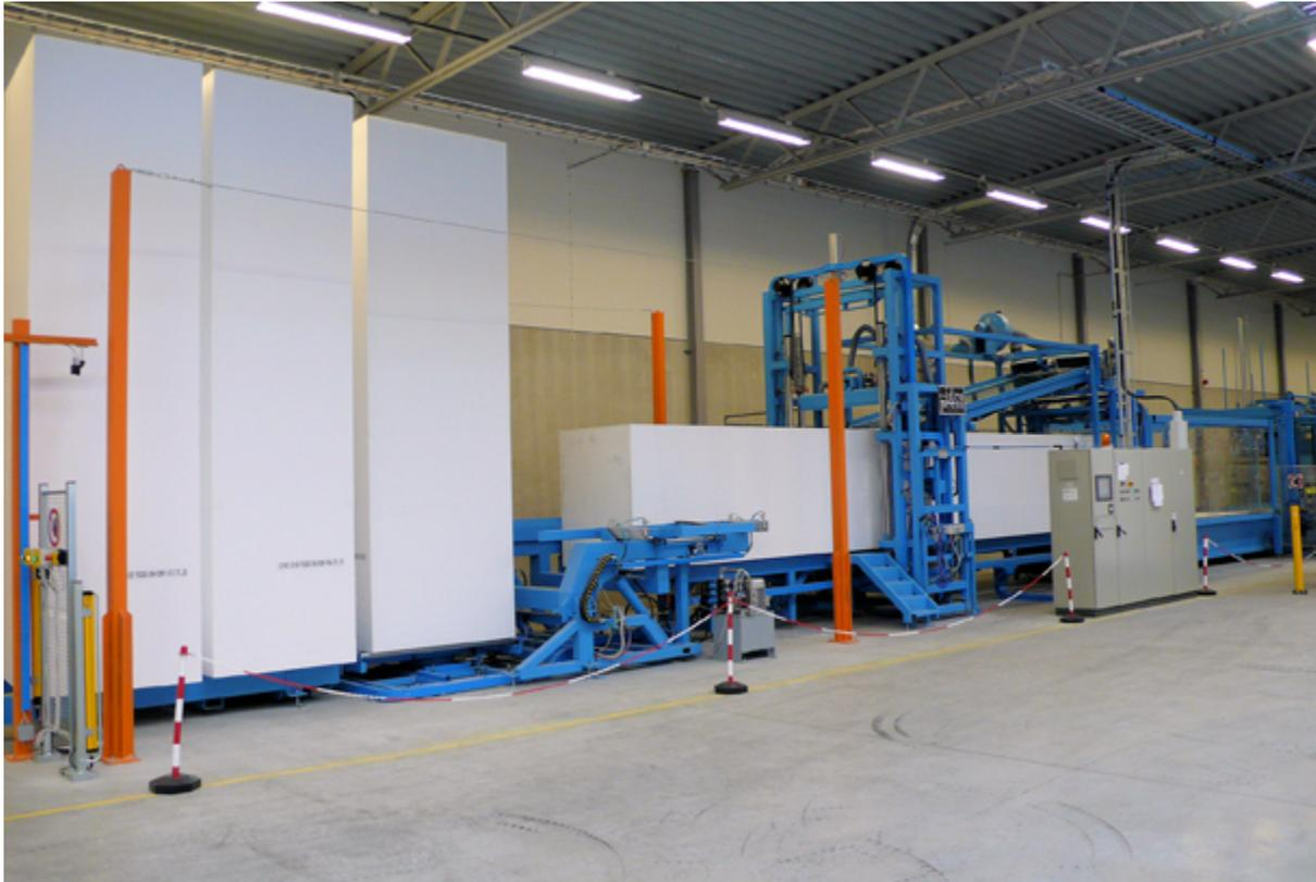
Las máquinas son controladas por PLC con interfaz de operador por medio de PC Industrial (de marca Panel), tipo Fanless y la pantalla táctil de 15 ". El sistema de control muestra el estado de todos los componentes de la máquina.
