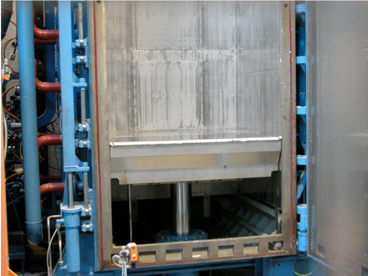
El único plano de cierre de la máquina asegura una perfecta estanqueidad de la presión del vapor y del vacío.
