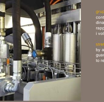
**gruppo di stirro/soffiaggio**, tutte le soffiatrici SIAPI sono dotate di impianto di stirro controllato elettricamente da un motore Brushless e da PLC. Questo permette il controllo dinamico del movimento aste, per garantire la perfezione del processo anche nei casi di rapporti di stirro non standard. L'impianto di soffiaggio, è studiato al fine di ridurre al massimo i volumi d'aria inutilizzati, permettendo elevati risparmi energetici.
