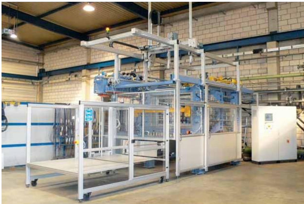
Ilustración: HEITZ HS 1309 INCENTIVE con robot de manipulación y mesa de apilamiento
