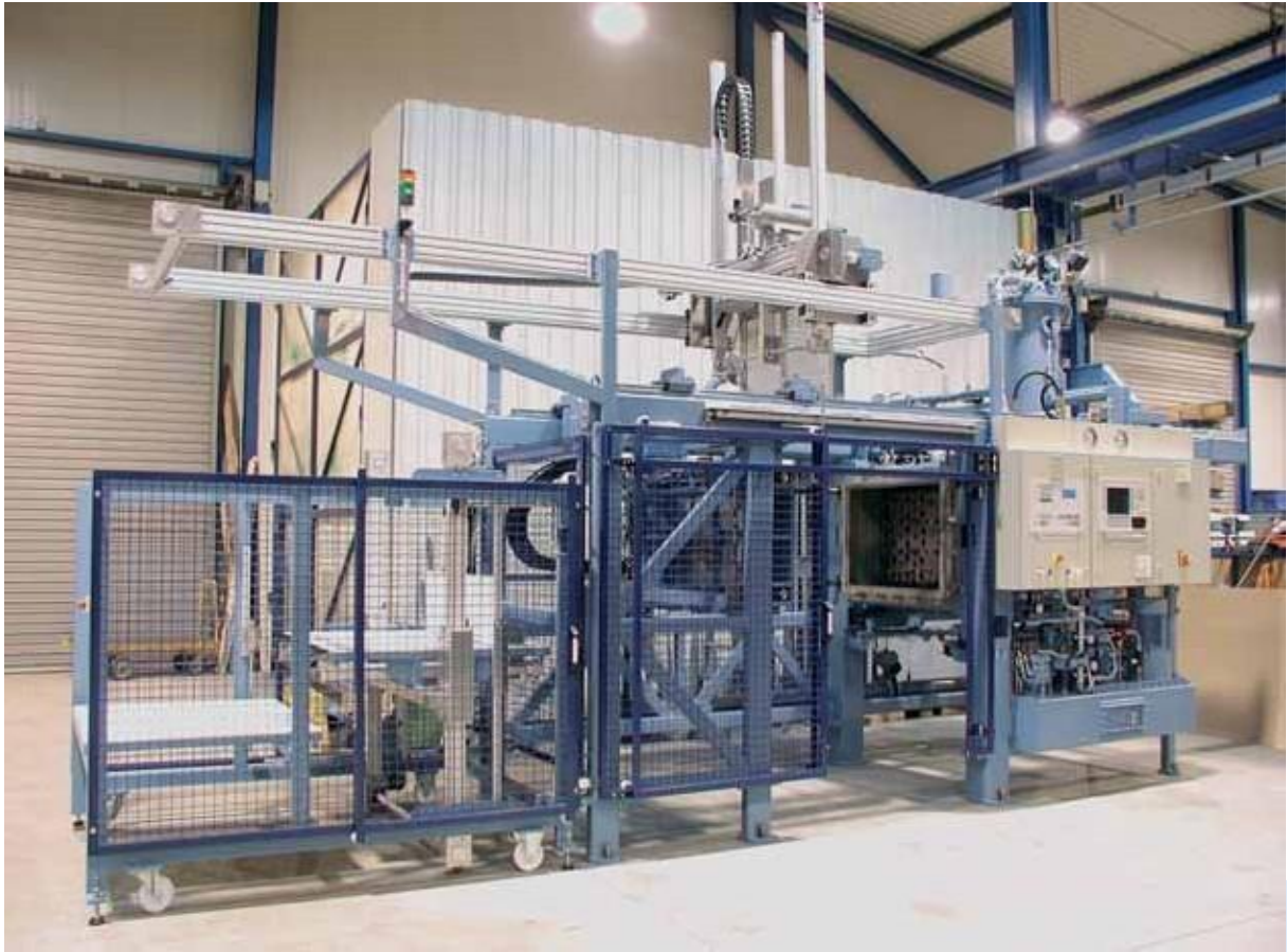
Ilustración HEITZ con robot manipulador y mesa de apilamiento
